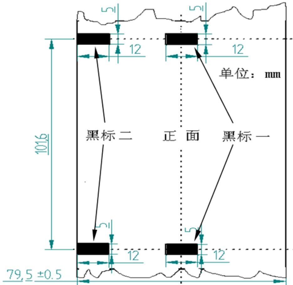
图一 打印纸打印面
